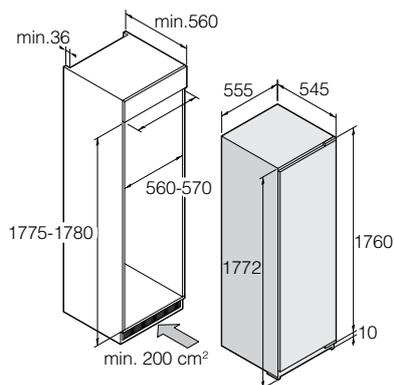
Dimensions de l'appareil et d'encastrement
