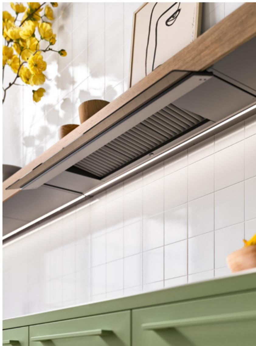
La version évacuation de Shelf est équipée d'un système exclusif No-Drop doté de filtres en technopolymère qui piègent la vapeur d'eau, et permettent ainsi d'éviter tout problème éventuel lié aux gouttes de vapeur condensée qui tomberaient sur les plaques de cuisson. La tuyauterie nécessaire à l'évacuation de l'air est dissimulée à l'intérieur d'une contre-cloison, ce qui permet à la hotte de conserver son design épuré et raffiné.
