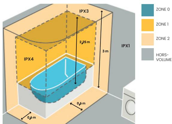
■ Protection IP 22, l'utilisation de ce radiateur est parfaitement sécurisée dans les salles de bain et peut être installé en zone 2 et en zone hors-volume.
